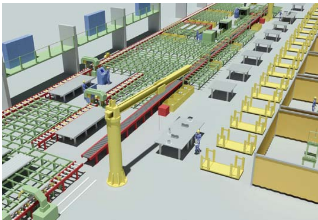
Ein sinnvoller Materialfluss geht kontinuierlich in die gleiche Richtung
